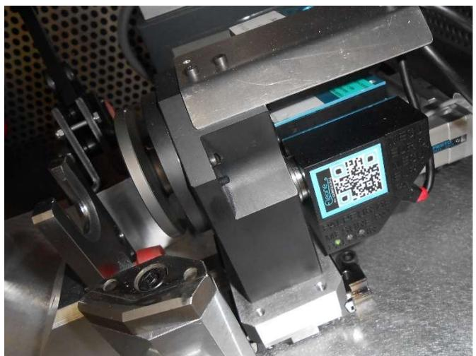
**RFIT** (Receiver Facilitating Identification and Traceability) est une solution de mesure semi-automatisée qui permet aux opérateurs d'être guidés dans l'ordre des points à contrôler tout en garantissant une traçabilité et une fiabilité des données. Une fois la mesure traitée par le logiciel ELEONE, une information visuelle est renvoyée directement à l'opérateur via un jeu de LED colorées.
